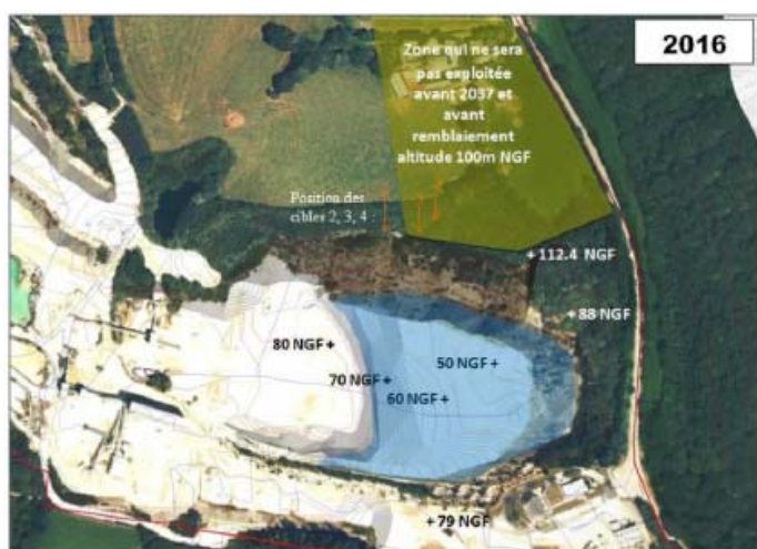
2016 : Vue aérienne actuelle de la fosse de Kerhoantec après 12ans de remblaiement de stabilisation (2004-2016)
