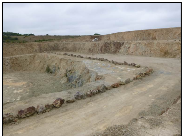
Merlons ou blocs rocheux le long des pistes
